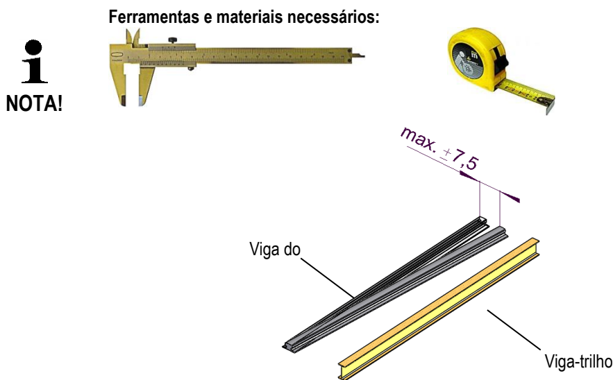
Fig. 8: Alinhamento horizontal ruim entre a viga do guindaste e a viga-trilho
